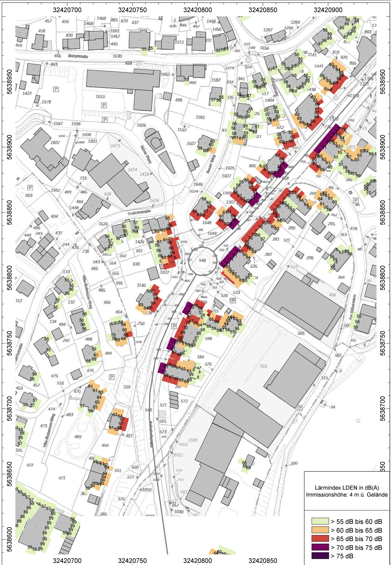
Abb. 10.5.7 Lärmindex LDEN ab 55 dB(A) - Bahnhofstraße im Bereich zwischen Straße Silberstern und Villa-Bubbenzer-Weg - Tempo 50 gemäß CNOSSOS
