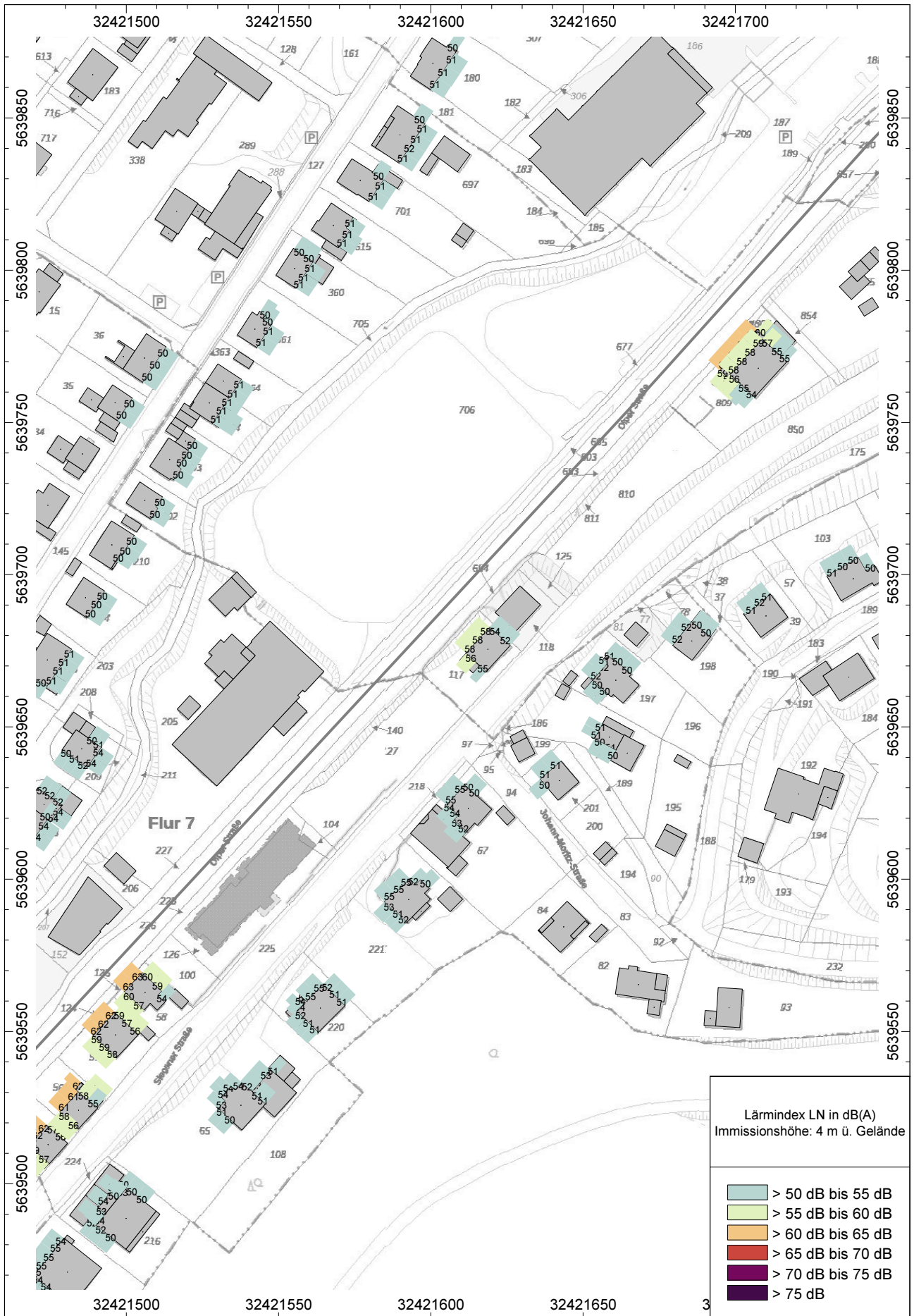
Abb. 10.5.11 Lärmindex L_N ab 50 dB(A) Olper Straße zwischen Weibeweg und Mühlenstraße - Tempo 50 gemäß CNOSS05
