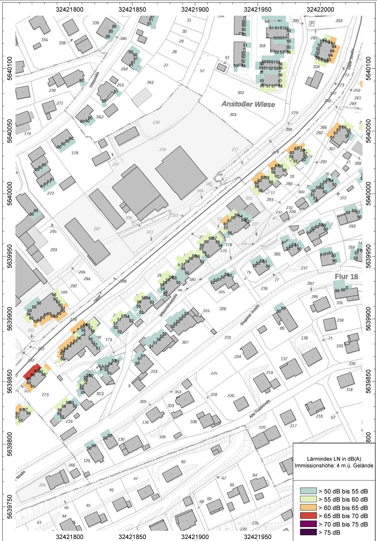
Abb. 10.5.10 Lärmindex L N ab 50 dB(A) - Opper Straße zwischen Buchenstrasse und Weibeweg - Tempo 50 gemäß CNOSSOS
