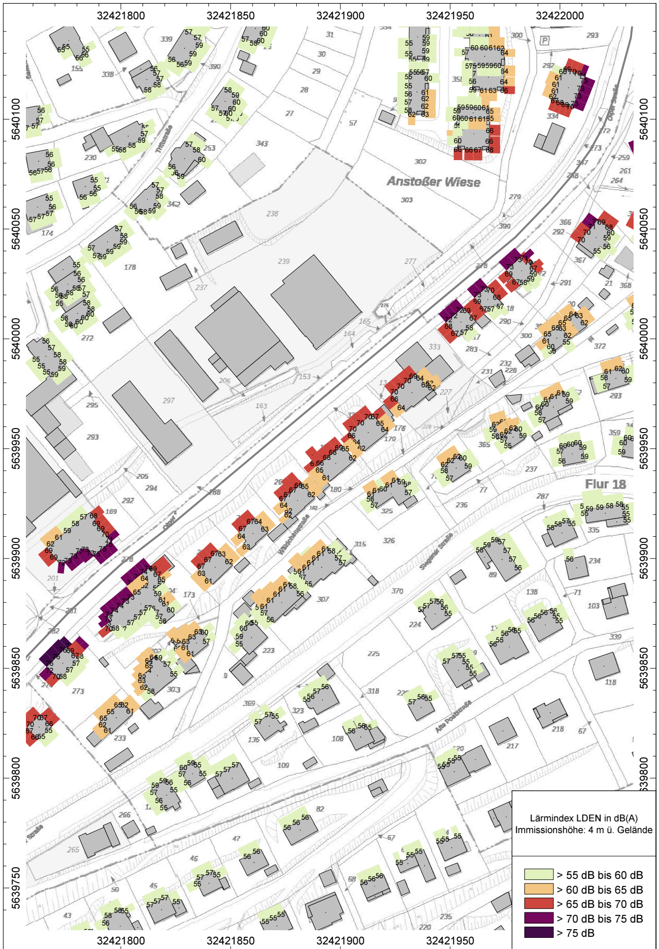
Abb. 10.5.3 Lärmindex L DEN ab 55 dB(A) - Olper Straße zwischen Buchenstraße und Weibeweg - Tempo 50 gemäß CNOSS05
